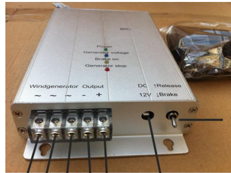
Vers l'éolienne Vers l'onduleur Transformateur 12V à brancher sur une prise
